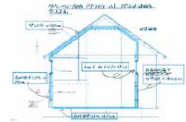
全館をぐるっと包む工事を行い、薪の消費を 抑える
