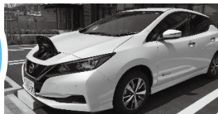
リーフ自体を蓄電池として活用 非常時の緊急用コンセントから電力を供給。 BCP対策としても強化されました。
