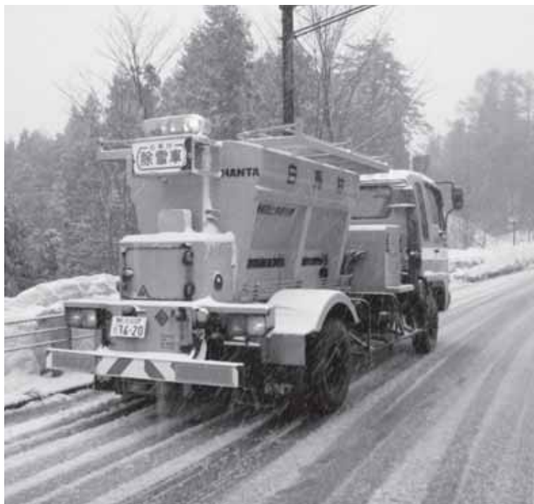
融雪剤散布状況
