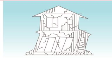
柱・梁・壁が破壊され、居住空間が欠損している状態。
