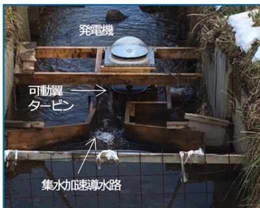
③水深 10 センチでも発電（鉄建建設）
