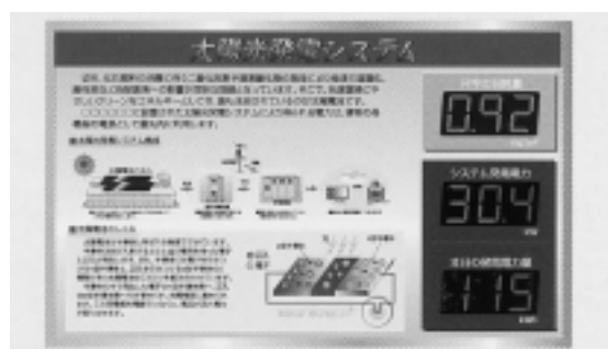
図 8.2.2.1-1 発電量表示パネル
