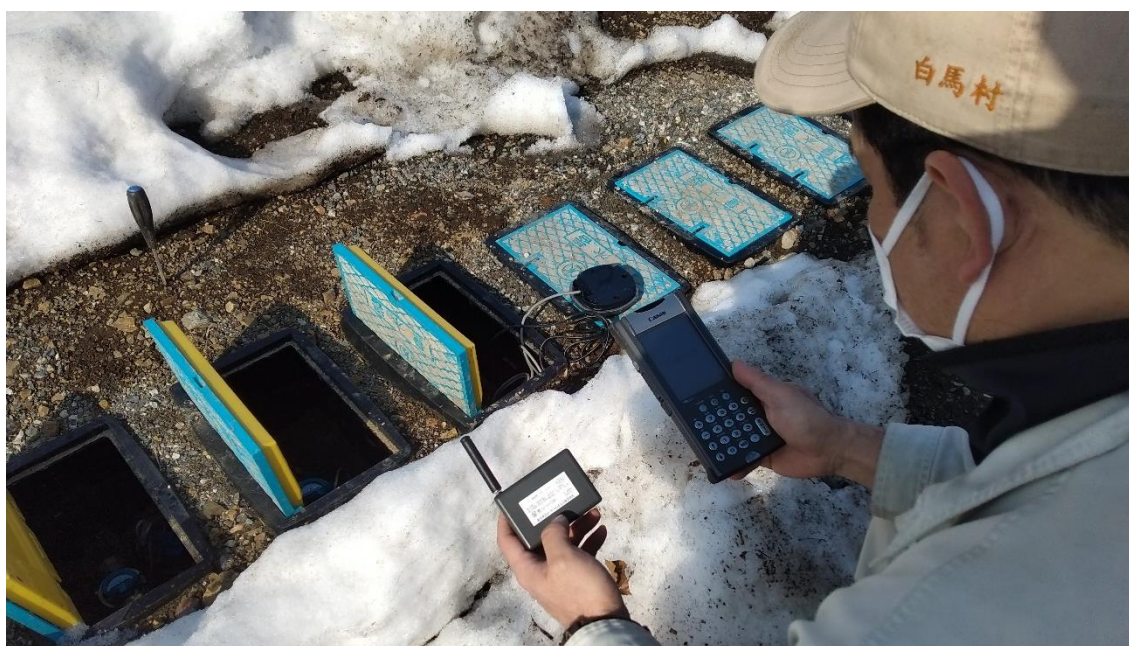
写真6-4 無線子機を取り付けた水道メーター(上)と受信テストの様子(下) (白馬村撮影)
