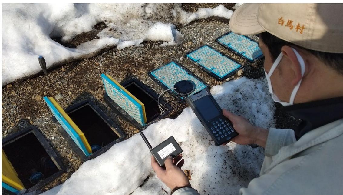
写真6-4 無線子機を取り付けた水道メーター(上)と受信テストの様子(下)
