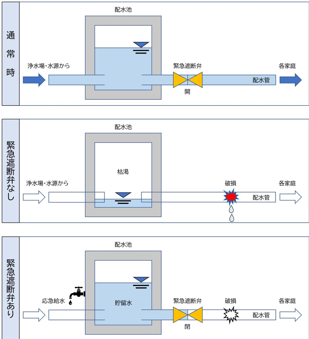
図4-2 緊急遮断弁の役割
